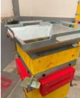
L'entonnoir SR permet de couler plus facilement le béton sans en projeter à l'extérieur du poteau.
