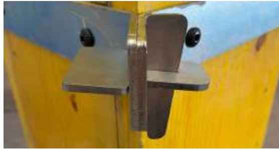
2 . Fixer les deux parties grâce aux armatures et aux clavettes et chevalets
